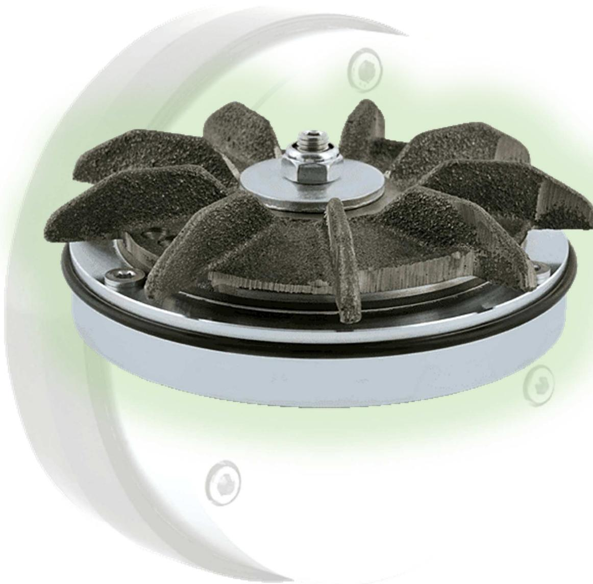
Тормоза питаются постоянным током - состоящий из электромагнита, якоря с фрикционной накладкой и чугунного вентилятора. Когда тормоз является включенным, тогда присоединяется якорь, одновременно отпуская для свободного вращения вентилятор, соединенный с валом при помощи клина.
